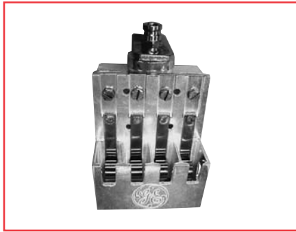
Reparación de Porta Escobillas
