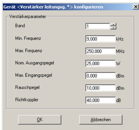
Bild 5-14 Dialog zur Konfiguration des leitungsgebundenen Verstärkers
