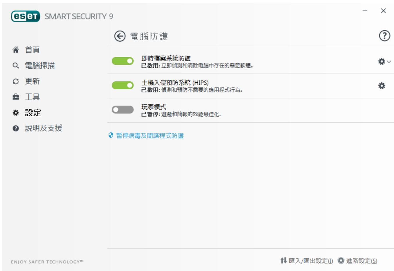
**暫停病毒及間諜程式防護** - 停用所有病毒及間諜程式防護模組。當您停用防護之後，視窗將會開啟，您可在該處使用 **[時間間隔]** 下拉式功能表來決定停用防護的時間長度。按一下 **[確定]** 以確認。
