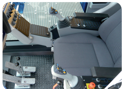
Kundenspezifischer J4 Joystick in Bedienkonsole
