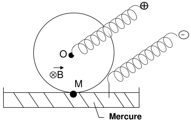
On admettra que la roue n'est en contact avec le mercure qu'en un point M et que le courant ne traverse la roue que suivant le rayon OM.
