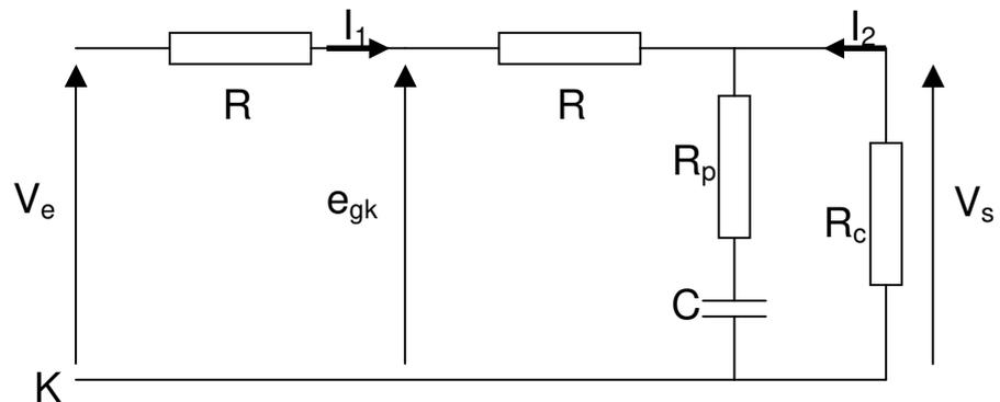
1°) Calculer la tension de sortie  $V_s$  du circuit électronique équivalent à un quadripôle, non figuré, ci-dessus. On l'exprimera en fonction du courant  $I_2$
