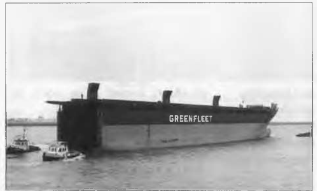
Fig. 5 en 6. Het achterschip van de Marion Green ligt in het bouwdek klaar voor koppeling met het in Turkije gebouwde midden- en voorschip, dat door sleepboten naar het dok wordt gevaren (foto's: Schelde Scheepsnieuwbouw).
