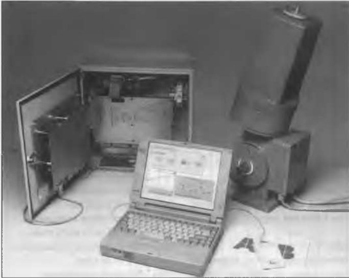
Fig. 1. De digitale toerenregelaar, DEGO-III, garandeert een gewenst toerental van dieselmotoren ongeacht de belastingsituatie.
