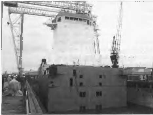
Fig. 5 en 6. Het achterschip van de Marion Green ligt in het bouwdek klaar voor koppeling met het in Turkije gebouwde midden- en voorschip, dat door sleepboten naar het dok wordt gevaren (foto's: Schelde Scheepsnieuwbouw).
