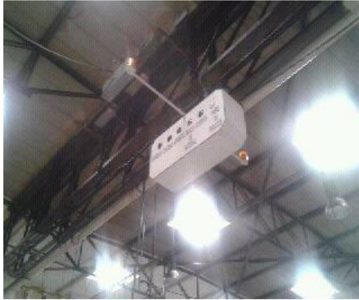
*Figura 19 Colocación del Andón en el área de torneado*
