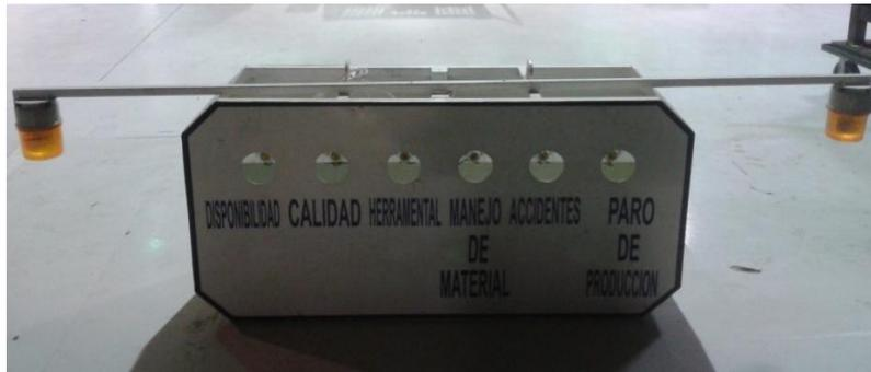
*Figura 10 Estructura del tablero Andon*
