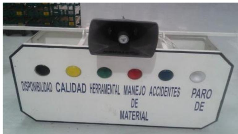
*Figura 11 Colocación de focos y bocina*
