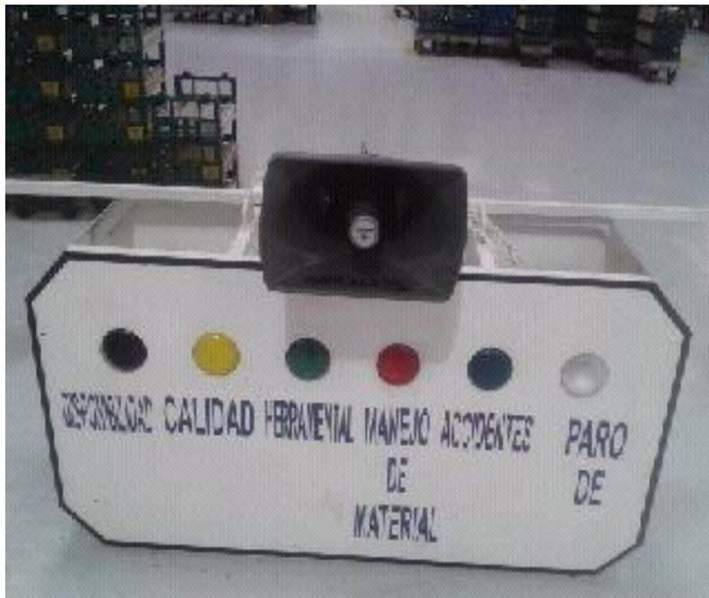
*Figura 18 Andon con todos sus componentes*
