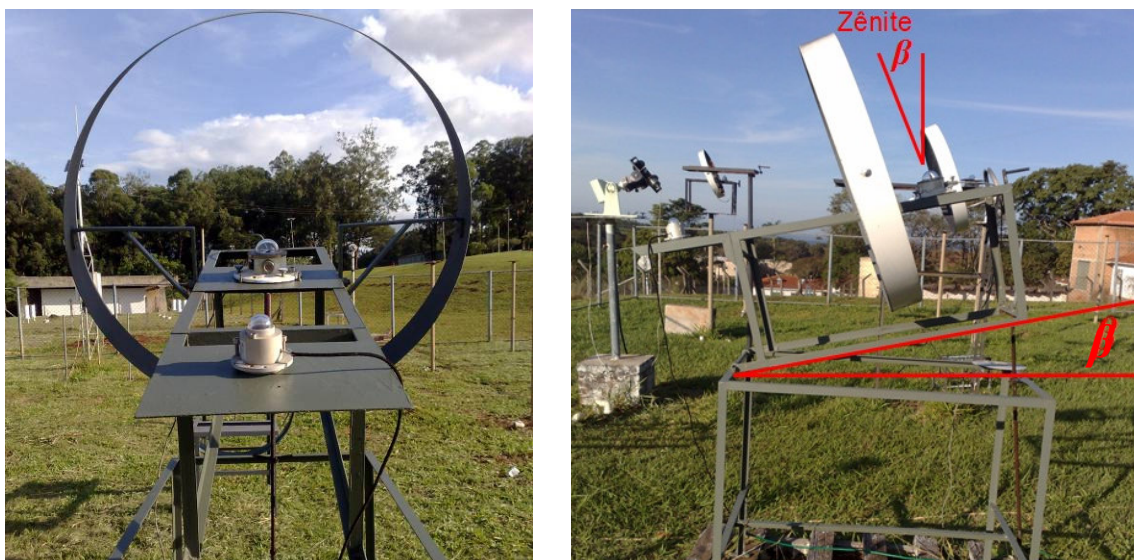
Figura 7. Piranômetros para medida da irradiância global e difusa em superfícies inclinadas, com a irradiância difusa sendo medida pelo anel de sombreamento ME.
