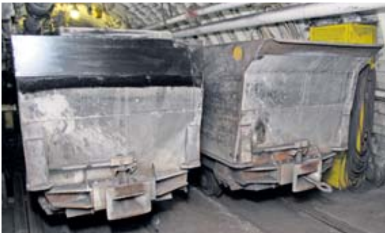
Vpravo původní „nosatý“ velkokapacitní vůz, vlevo po úpravě.
