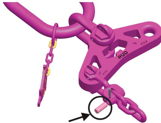
Abb 5: VIP-G-Bolzen einfügen
