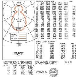
TESTED IN ACCORDANCE WITH IES PROCEDURES, TEST DISTANCE EXCEEDS 25.0 FEET
