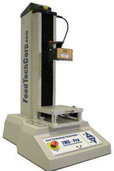
Sl. 14. Instrument za merenje teksture hrane TMS-PRO ( www.foodtechcorp.com )
