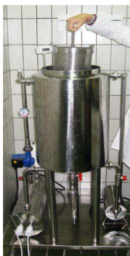
Sl. 6. Uređaj za osmotsko sušenje ( Mišljenović et al, 2011 )
