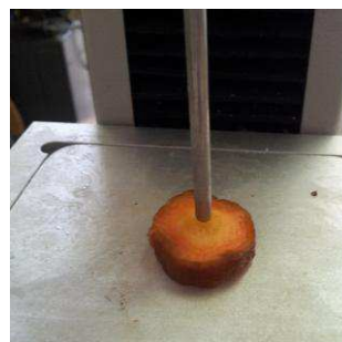
Sl. 16. Test prodiranja na mestu floema na svežem i osmotski sušenom uzorku korena mrkve
