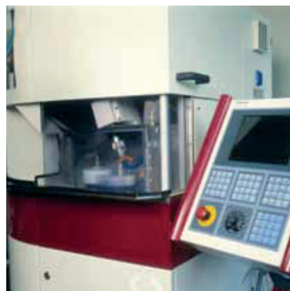
Optikfertigung mit CNC Poliermaschine
