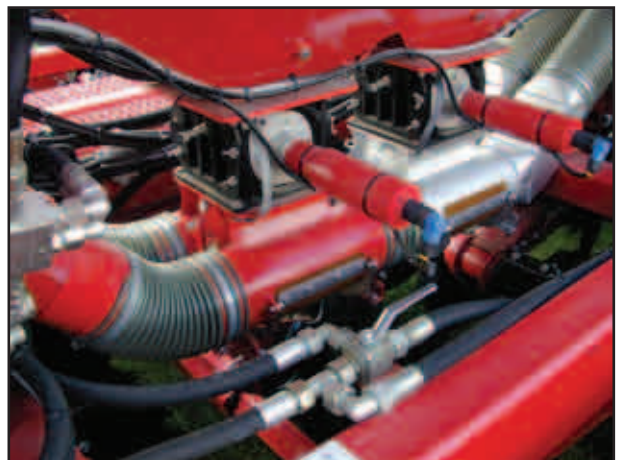
Dosificadores con accionamiento, tapa de caída y sistema neumático
