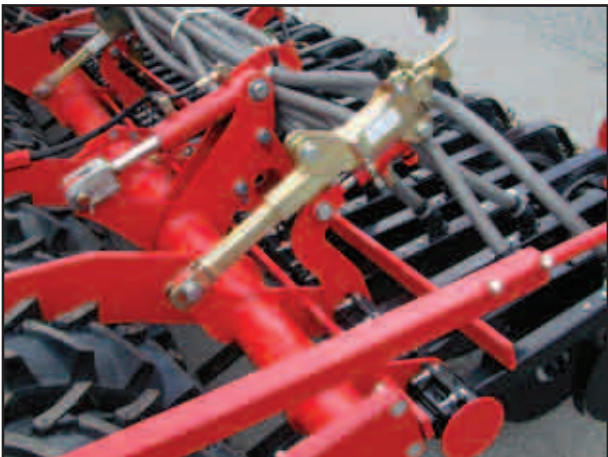
Ajuste hidráulico de la presión de las rejas
