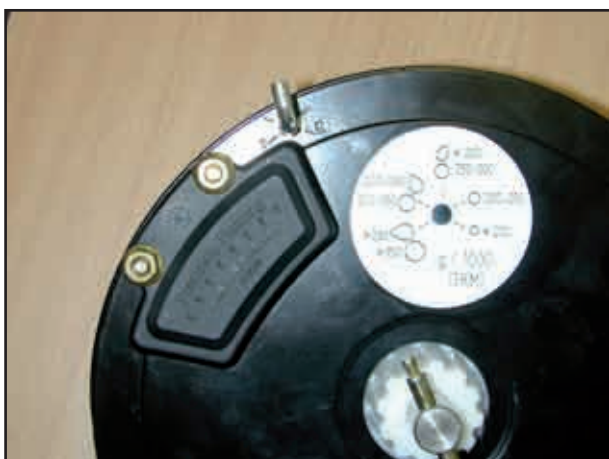
Ustawienie szczotki z ilustracją ustawień i płytą odbojową
