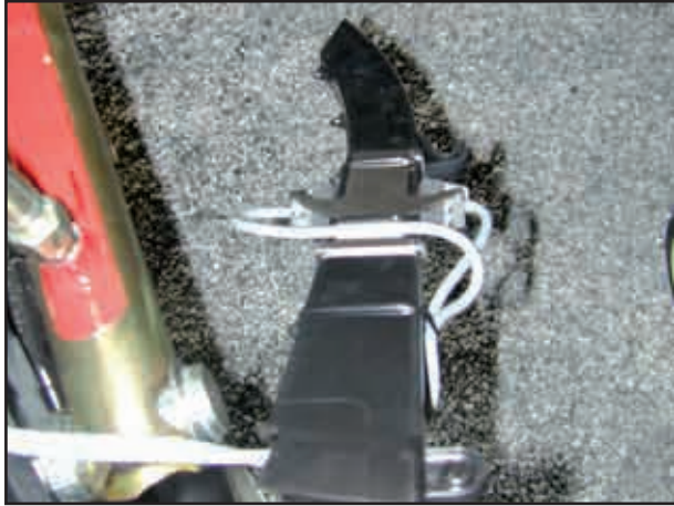
Rura spadowa z czujnikiem liczenia ziaren
