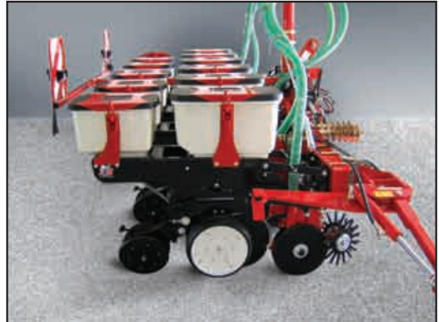
Jednostka siewna z instalacją z mikrogranulatem
