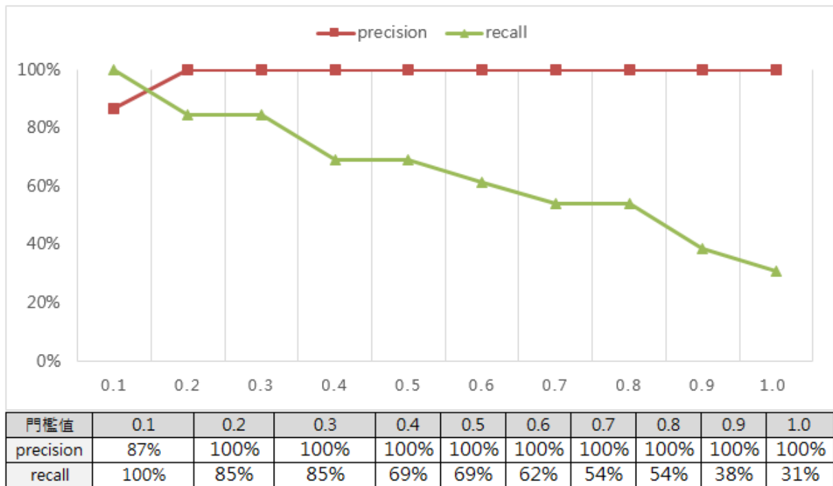
圖 4.13: 利用實例資訊進行整合時，門檻值不同而造成精確率與完整率的變化
