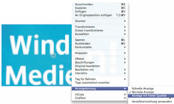
Abbildung 3.3: Die niedrig aufgelöste Vorschau einer EPS-Datei kann mit hochauflösender Anzeigeleistung optimal wiedergegeben werden.
