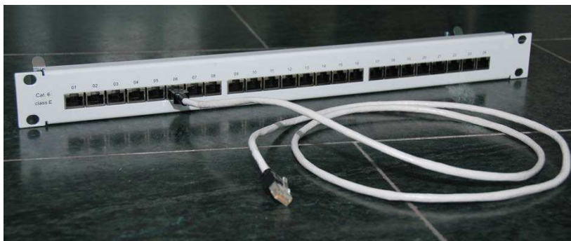
Abbildung 3 Kategorie 6 Verteilerfeld und Verteilerkabel mit RJ-45 Steckern
