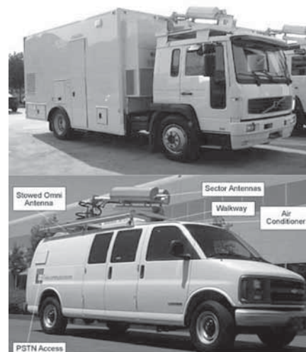
Obr. 4 - Vozidlové mikrosítě GSM Network-On-Wheels firmy interWAVE
