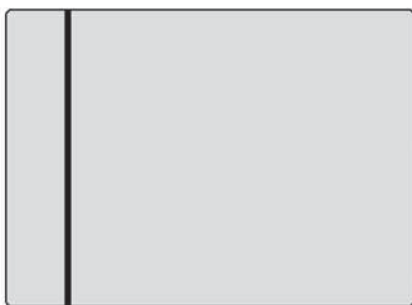
Obr. 9a - Nastavení svislé čáry (stopy) na obrazovce televizoru TESLA COLOR 419. Úhlopříčka obrazovky 56 cm. Nastavení černá stopa při bílém pozadí.
