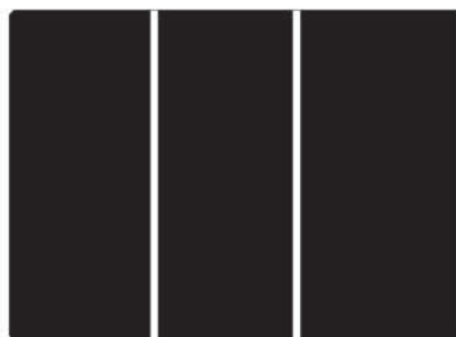
Obr. 9b - Nastavení dvou svislých stop na obrazovce televizoru TESLA COLOR 419 při kontrole správnosti zapojení přípravku. Pro srovnání se snímkem 9a jsou na snímku 9b bílé stopy na černém pozadí. Barvu stopy a pozadí můžeme volit dle způsobu sloučení signálu, to je synchronizačních impulsů a signálu vyjadřujícího průběh sledovaného signálu. První způsob (černá stopa) je vhodnější vzhledem k menšímu nebezpečí vypalování obrazovky nadměrným místním přejasněním, která je z tohoto hlediska méně odolná než stínítka běžných osciloskopů.
