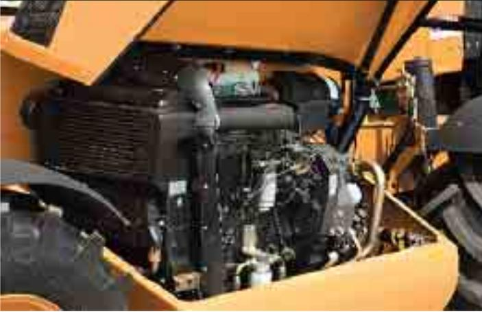
Las manipuladoras telescópicas TX se accionan con un motor turboalimentado Case de 4,5 litros. Todas las máquinas están equipadas con un motor respetuoso con el medio ambiente Tier III, de emisiones reducidas, que con turbocompresor y aftercooler ofrece desde 99 CV a unos fantásticos 118 CV y un potente par de 516 Nm.
