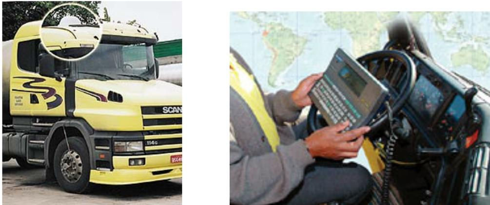
Figura 6: Terminal de Comunicação Móvel (MCT) e Antenas
