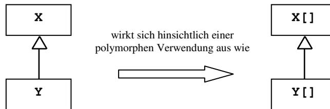
Einer **Array-Variablen** vom Typ **X[]** kann dadurch auch die Referenz auf ein **Y[]-Objekt** zugewiesen werden.
