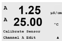
Accédez au mode Calibration conformément à la description de la section 7.1. Si vous utilisez un transmetteur à deux canaux, sélectionnez le canal. Pour tous les modèles, sélectionnez Modifier.
