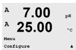
En mode Mesure, appuyez sur la touche . Appuyez sur la touche ou pour naviguer jusqu'au menu Configuration. Après avoir sélectionné le menu de configuration, appuyez sur [ENTER]. Saisissez le code de sécurité de la configuration « xxxx » si nécessaire (voir section 9.3) Appuyez sur [ENTER] pour confirmer le code.
