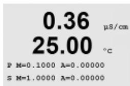
La sélection de l'option Données de calibration affiche les constantes de calibration de la pente (M) et du décalage (A). Utilisez les touches Haut et Bas pour basculer entre les canaux A et B sur les transmetteurs à deux canaux.
