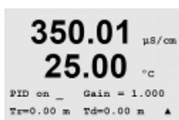
Affectez la mesure a, b, c ou d à contrôler après le paramètre « PID on\_ » (PID sur\_). Réglez le gain (sans unité), le paramètre temps de réinitialisation (en minutes), ainsi que vitesse ou temps dérivé (en minutes) requis pour le contrôle. Appuyez sur la touche [ENTER]. Gain, Réinitialisation et vitesse sont réglés ultérieurement sur la base d'essais et d'erreurs issus de la réponse du procédé.
