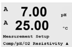
Appuyez sur la touche [ENTER] pour sélectionner ce menu. Paramètre additional peut être configuré : conductivity, pH and O2.
