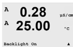
Les paramètres disponibles sont activation, activation 50 % ou désactivation auto 50 %. Si désactivation auto 50% est sélectionné, le rétroéclairage se limite à 50 % de ses capacités après 4 minutes d'inactivité au niveau du clavier. Le rétroéclairage s'active de nouveau automatiquement si une touche est enfoncée.
