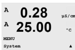
En mode Mesure, appuyez sur la touche . Appuyez sur la touche ou pour naviguer jusqu'au menu Système et appuyez sur [ENTER]. Saisissez le code de sécurité « xxxx » si nécessaire (voir section 9.3), puis appuyez sur [ENTER] pour confirmer le code.
