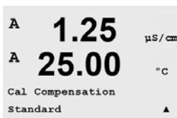
Après avoir sélectionné le calibrage de sonde souhaité et avoir appuyé sur [ENTER], l'écran suivant propose de choisir le type de mode de compensation de température désiré lors du procédé de calibrage. Les choix sont Aucun, Standard, Léger 84, Std 75°C, Linéaire = 02.0%/°C (valeur définissable par l'utilisateur), Glycol.5, Glycol1 et Alcool.
