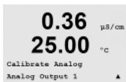
Sélectionnez la sortie analogique à calibrer. Chaque sortie analogique peut être calibrée à 4 et 20 mA.
