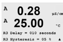
Encodez l'hystérésis sous la forme d'un pourcentage. Une valeur d'hystérésis nécessite que la mesure revienne dans les limites du seuil selon un pourcentage spécifié avant la désactivation du relais.
