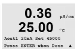
Lorsque le nombre à cinq chiffres augmente, le courant aussi ; lorsque le nombre diminue, le courant de la sortie suit la même courbe. Par conséquent, des changements approximatifs peuvent être apportés au courant de sortie en modifiant les chiffres des centaines et des milliers ; des changements précis peuvent être effectués en modifiant les chiffres des dizaines et des unités.
