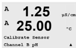
Ce transmetteur se caractérise par différents types de calibration (en un point, en deux points ou procédé) et présente 8 jeux de tampons prédéfinis ou une possibilité de saisie manuelle. Pour calibrer l'instrument, vous avez besoin d'une solution tampon pH standard correspondant à l'une de ces valeurs. Accédez au mode Calibration conformément à la description de la section 7.2. Un H clignote dans l'angle supérieur gauche de l'écran pour indiquer qu'un calibrage est en cours.
