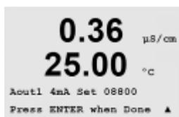
Connectez un milliampèremètre précis à la sortie analogique, puis ajustez le nombre à cinq chiffres à l'écran pour régler la sortie sur 4.00 mA. Répétez l'opération pour 20.00 mA.
