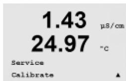
Le menu Calibrage présente les options de calibrage du transmetteur et des sorties analogiques, ainsi que la fonction de déverrouillage du calibrage.
