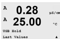
Celui-ci peut être réglé sur Off (Inactif) ou Last values (Dernières valeurs). Un dispositif hôte externe peut sonder le M300 à la recherche de données. Si la fonction Maintien USB est réglée sur Off (Inactive), les valeurs actuelles sont renvoyées. Si la fonction Maintien USB est réglée sur Last Values, les valeurs présentes au moment de l'activation du maintien sont renvoyées.
