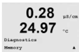
Si le menu Mémoire est sélectionné, le transmetteur effectue un test sur la mémoire vive (RAM) et la mémoire morte (ROM). Des modèles de test sont écrits sur tous les emplacements de la mémoire vive, d'autres sont lus à partir de ces mêmes emplacements. La somme de contrôle ROM est recalculée et comparée à la valeur enregistrée dans la mémoire morte.
