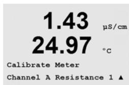
Lorsque Calibrage de l'appareil de mesure est sélectionné, l'écran affiche Canal A et Résistance 1, indiquant ainsi que le transmetteur est prêt à calibrer la première résistance du canal A. Cette résistance peut être modifiée en sélectionnant le domaine de 1 à 5 ou la température. Chaque domaine de résistance nécessite un calibrage en deux points. Le calibrage de la température est un calibrage en trois points (voir le tableau des valeurs de résistance de température).
