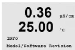
La sélection de Modèle/version logicielle fait apparaître le numéro du modèle, le numéro de série et la version du logiciel installée.
