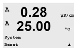
Ce menu permet d'accéder aux options suivantes : Réinitialisation système, Réinitialisation cal. instrument, Réinitialisation cal. analogique.
