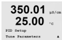
Le menu Paramètres de réglage affecte un contrôle à une mesure et définit le seuil, les paramètres de réglage et les fonctions non linéaires du contrôleur par le biais d'une série d'écrans.
