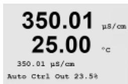
En mode de mesure normal, cet écran indique l'état de la régulation du PID. Si PID Display est sélectionné, l'état (Man ou Auto) ainsi que la sortie de contrôle (%) s'affichent sur la ligne inférieure. En outre, pour que l'affichage soit activé, une mesure doit être attribuée sous Paramètres de réglages et un relais ou une sortie analogique doit être attribué(e) sous Mode.
