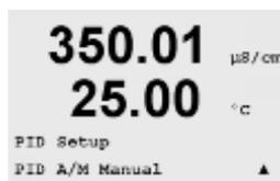
Le menu Affichage PID Auto-Manuel permet de choisir entre un fonctionnement automatique ou manuel. Choisissez le mode de fonctionnement de l'écran PID (Auto ou Manual). Appuyez sur [ENTER] pour afficher la boîte de dialogue Enregistrer les modifications.
