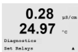
Le menu de diagnostic Réglage du relais permet d'activer/désactiver chaque relais. Pour accéder aux relais 5 et 6 sur les transmetteurs à deux canaux, appuyez sur [ENTER].
