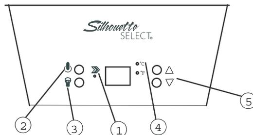
5. '△' HAUT bouton de commande Augmenter la température (plus chaud) par intervalle de un degré
