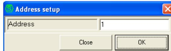
Introduzca la dirección "1" de la central y, a continuación, haga clic en OK. Aparecerá inmediatamente la barra de descarga. Mientras dure este proceso, no podrá realizar ninguna otra función en la central ni supervisar las entradas.
