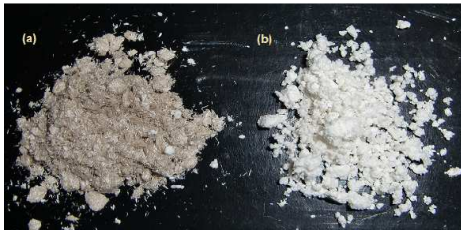
Figura 5.16. Aspecto físico da cafeína antes (a) e depois do processamento (b) por SAS.
