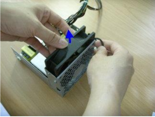
Figure 31 : : Remove PSU FAN
