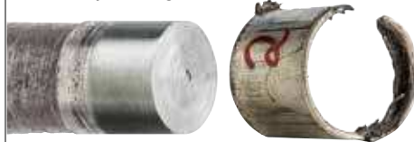
Versión con cojinete metálico sobre eje St52 galvanizado
