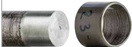
Versión con iglidur® Q290 sobre eje galvanizado
