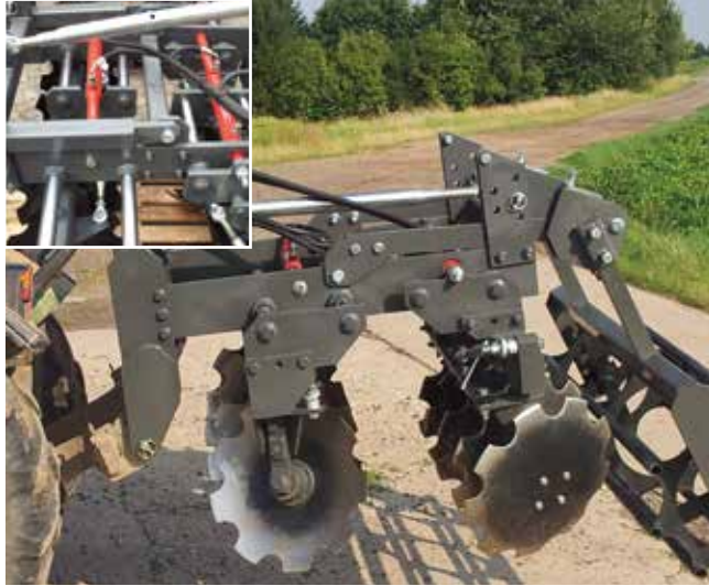
Arado de discos (ajuste de anchura)
