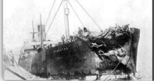
Storstad fikk store skader i baugen, men kunne gå for egen maskin.
