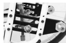
4° Sturz integriert, Spur unabhängig einstellbar
