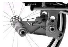
**Radstandsverlängerung über "Quick-Pins" abnehmbar, mit durchgehendem Achsrohr**
