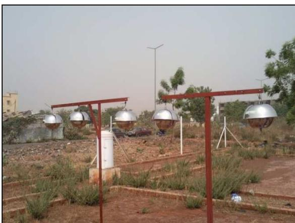
Figure 2: Échantillonneurs passifs d'air déployés sur le site de Bamako Centre
