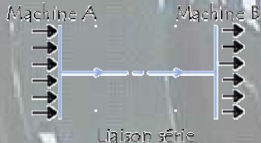
A l'origine les ports série permettaient uniquement d'envoyer des données, mais pas d'en recevoir, c'est pourquoi des ports bidirectionnels ont été mis au point (ceux qui équipent les ordinateurs actuels le sont); les ports séries bidirectionnels ont donc besoin de deux fils pour effectuer la communication.
