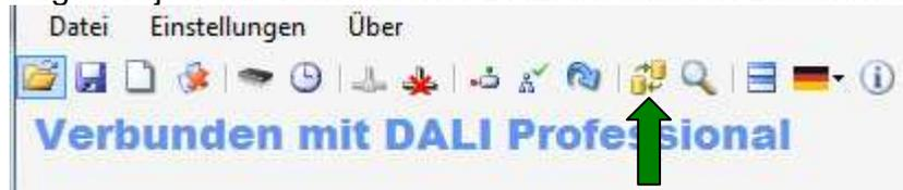
Funktioniert wie Suchprozess bei Erst-Inbetriebnahme, dabei wird aber zusätzlich der Name vorgegeben. Bereits benutzte Namen ohne zugeordnetes Gerät werden im Auswahlmenü angezeigt und ausgewählt. Neu gefundenen Geräte sind blau, bereits vorhandene / benannte Geräte sind grün.
