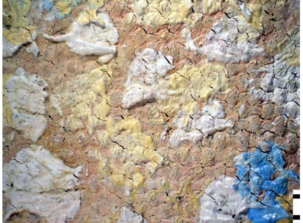
Abb. 11 Rosafarbene, partielle Untermalungsschicht, gefolgt von gelben und weißen Farbaufträgen, Mikroskopaufnahme (M = 1 mm)
