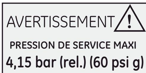
Cet autocollant indique la pression hydraulique maximale de service dans les conduites. Le dépassement de cette pression peut entraîner des dommages corporels et une défaillance de l'équipement.
