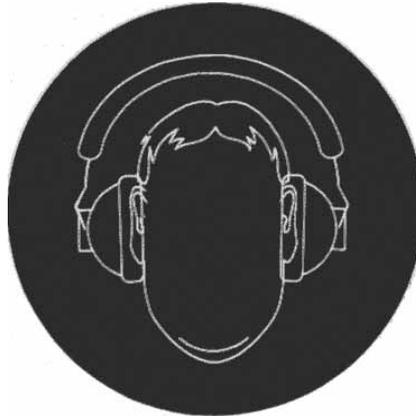
Cet autocollant indique qu'un casque anti-bruit doit être utilisé en cas de niveau sonore élevé.
