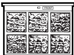
Filtro sucio – necesita limpieza
